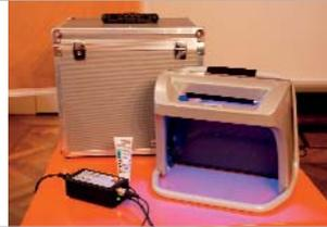
Es besteht aus dem Kästchen mit UV-Lampen und einem Anschlussteil. Für die Demonstration wird eine Testlotion benötigt. Das ist eine Creme, die mittels spezieller Zusätze unter UV-Licht fluoresziert, was durch den Sehschlitz oben am Gerät deutlich sichtbar wird (siehe Fotos unten).
